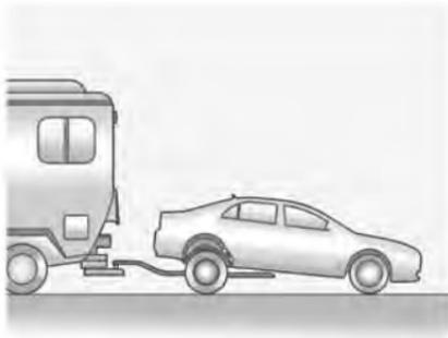
Для буксировки заднеприводного автомобиля с опорой на дорогу двух колес (задняя ось вывешена) выполните следующее:
