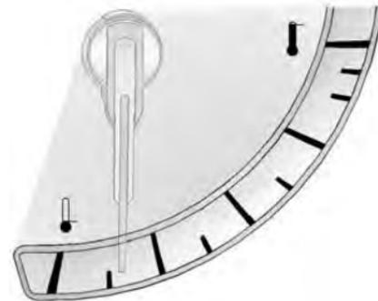
Данный указатель отображает температуру охлаждающей жидкости двигателя.
