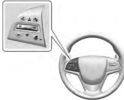
**Ⓢ**: для включения и выключения круиз-контроля нажмите на эту кнопку. Когда система активна, на комбинации приборов горит соответствующий индикатор.
