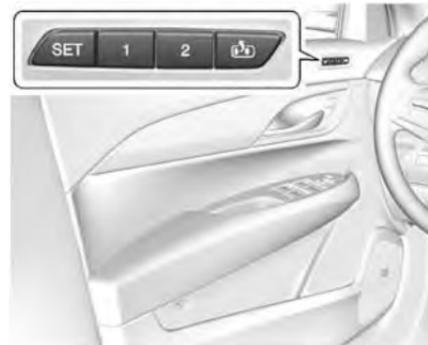
При соответствующей комплектации для сохранения и вызова сохраненных настроек (для регулировки положения сиденья водителя и наружных зеркал) можно использовать кнопки «1», «2», SET, и EXIT (при выходе), расположенные на двери водителя. Эти сохраненные вручную настройки называются сохраненными настройками регулировок упомянутых выше компонентов.
