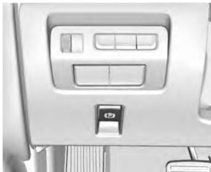
Данный автомобиль может быть оснащен стояночным тормозом с электроприводом (ЕРВ). Выключатель стояночного тормоза в этом случае находится на левой части приборной панели.
