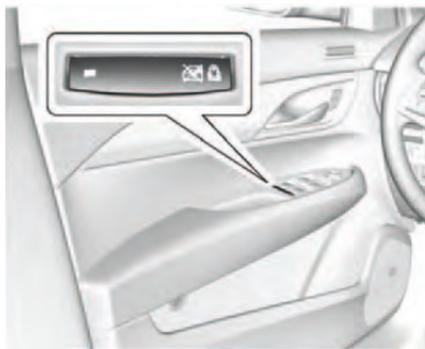
Данная функция предотвращает отпирание замков задних дверей изнутри пассажирами задних сидений.
