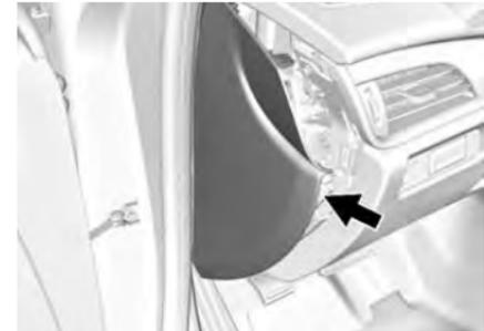
Для получения доступа к предохранителям снимите торцевую крышку приборной панели, осторожно последовательно поддевая крышку возле каждого фиксатора, начав с положения, показанного на рисунке.
