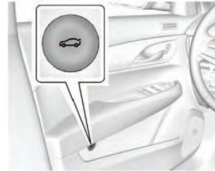
Для открывания двери багажного отделения нажмите кнопку
