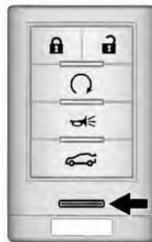
Чтобы извлечь ключ, нажмите кнопку, расположенную в нижней части пульта дистанционного управления, и извлеките ключ. Не допускается извлекать ключ, не нажимая кнопку.
