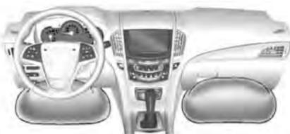
Модуль коленной подушки безопасности водителя расположен ниже рулевой колонки. Модуль коленной подушки безопасности переднего пассажира расположен под перчаточным ящиком.
