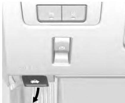
1. Потяните рукоятку разблокировки защелки капота, расположенную в пассажирском салоне. Она расположена слева в нижней части приборной панели.
