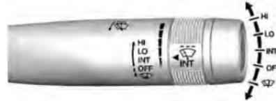
При положении ACC/ACCESSORY или ON/RUN/ START кнопки пуска двигателя/включения аксессуаров переместите рычаг выбора режимов очистителя/омывателя ветрового стекла, чтобы выбрать частоту движения щеток стеклоочистителя.
