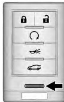
Нажмите кнопку разблокировки, расположенную в нижней части пульта управления для того, чтобы извлечь механический ключ. Механический ключ используется для управления замками двери водителя, зажигания и перчаточного ящика. См. «Ключи», стр. 2-2 и «Система дистанционного управления замками (RKE)», стр. 2-3.
