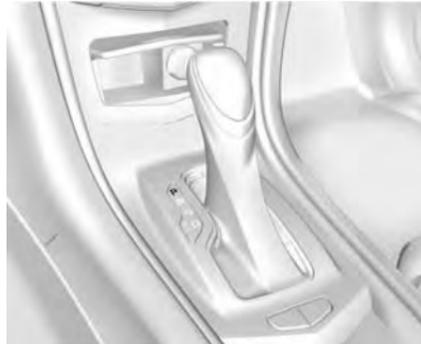
**«Р» (парковка):** в данном положении задние колеса автомобиля заблокированы. Поскольку при данном положении рычага селектора самопроизвольное движение автомобиля затруднено, используйте его при запуске двигателя.
