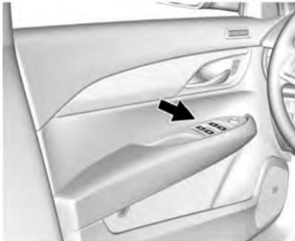
Электроприводы стеклоподъемников можно использовать только при положении ON/RUN или ACC/ACCESSORY кнопки пуска двигателя/включения аксессуаров, а также в режиме задержки отключения питания дополнительного оборудования (режим RAP). См. «Режим задержки отключения питания дополнительного электрооборудования (RAP)», стр. 9-25.
