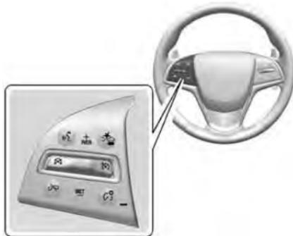
При соответствующей комплектации некоторые функции управления аудиосистемой могут выполняться с помощью кнопок, расположенных на рулевом колесе.
