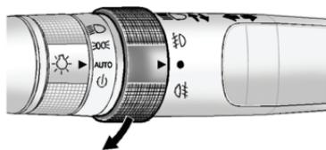
Переключатель противотуманных фар/фонарей расположен на левом комбинированном подрулевом переключателе – рядом с символами противотуманных фар/фонарей.
