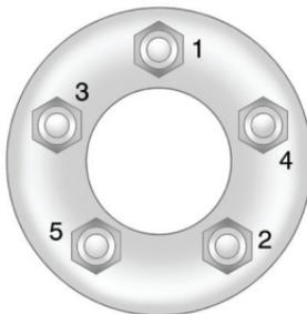
15. Надежно затягивайте колесные гайки в последовательности, указанной на рисунке.
