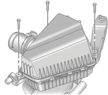
6. Снимите три винта крепления крышки воздухоочистителя.
