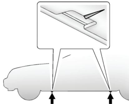
3. Найдите места установки домкрата, обозначенные V-образной выемками, расположенными на пластиковых облицовках порогов (см. рисунок).
