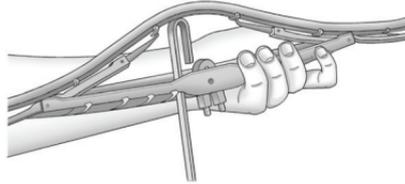
7. Установите новую щетку на J-образный конец рычага очистителя. Потяните за рычаг, чтобы зафиксировать его.
