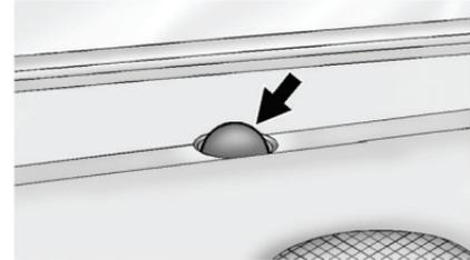
С помощью датчика интенсивности солнечного света, расположенного на приборной панели ближе к основанию ветрового стекла, определяется интенсивность солнечного излучения.
