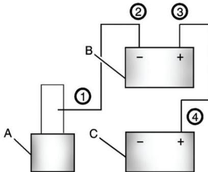
**Последовательность действий при отсоединении проводов для пуска двигателя от внешнего источника**
