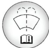
Откройте крышку с соответствующим символом. Долейте жидкость омывателей так, чтобы был заполнен весь бачок. Более подробная информация о расположении бачка приведена в разделе «*Моторный отсек*», стр. 9-5.
