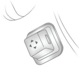
На автомобилях с электроприводом регулировки положения рулевого колеса переключатель расположен слева от рулевой колонки.
