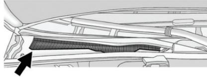
Фильтрующий элемент воздухоочистителя системы вентиляции расположен в моторном отсеке под рычагом очистителя ветрового стекла и кожухом, расположенным со стороны переднего пассажира.
