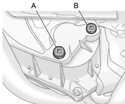
A. Пробка сливного отверстия.
