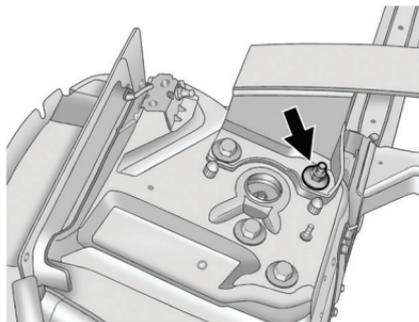
Ваш автомобиль оборудован вынесенной «отрицательной» (-) клеммой, как показано на рисунке. Она расположена в моторном отсеке, со стороны водителя. См. раздел «Моторный отсек», стр. 9-5. Следует всегда пользоваться вынесенными клеммами, а не клеммами аккумуляторной батареи.
