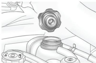
2. Медленно отверните крышку, а затем осторожно снимите ее.
