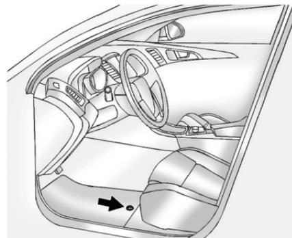
1. Чтобы разблокировать фиксатор и снять коврик, потяните вверх заднюю часть напольного коврика.
