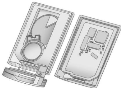
1. Извлеките ключ из пульта дистанционного управления, нажав узкую кнопку, расположенную в нижней части пульта дистанционного управления. Не извлекайте ключ без нажатия кнопки.
