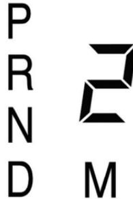
На тахометр выводится информация о выбранной в данный момент передаче. Цифра обозначает диапазон, выбираемый при перемещении рычага селектора вперед или назад.
