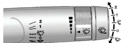
Переключатель омывателя/очистителя ветрового стекла расположен на правой части рулевой колонки.
