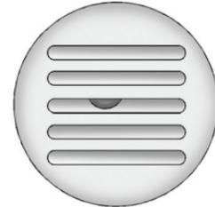
С помощью датчика температуры воздуха, расположенного на приборной панели около рулевого колеса, измеряется температура воздуха внутри автомобиля.
