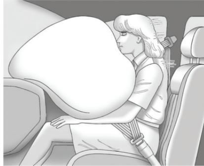
Модуль фронтальной подушки безопасности переднего пассажира встроен в приборную панель со стороны переднего пассажира.
