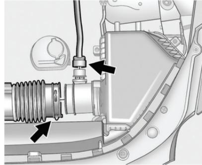
3. Отсоедините электрический разъем от воздухоприемного патрубка.
