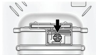
2. Снимите фиксатор герметика для шин и компрессора.
