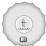
На крышке бачка жидкости гидропривода выключения сцепления нанесен данный символ. Более подробная информация о расположении бачка приведена в разделе «*Моторный отсек*», стр. 9-5.
