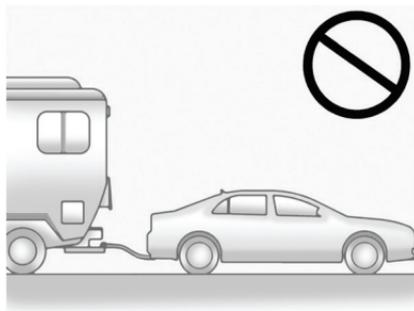
**Важно:** Если автомобиль буксирится с опорой всех четырех колес на дорогу, могут быть повреждены компоненты трансмиссии. В этом случае гарантия производителя на устранение возможных повреждений не распространяется. Не буксируйте автомобиль с опорой всех четырех колес на дорогу.
