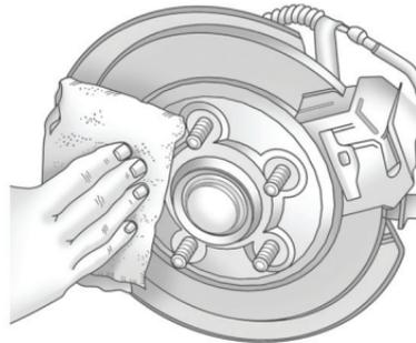
10. Удалите грязь и ржавчину со шпилек, привалочной плоскости колеса и запасного колеса.
