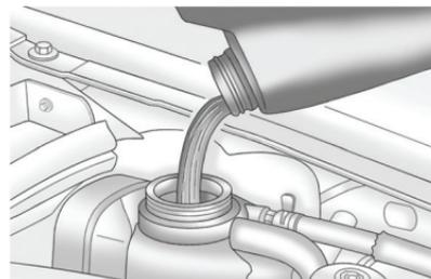
3. Доливайте охлаждающую жидкость в расширительный бачок так, чтобы ее уровень был немного выше метки FROID/FULL COLD.
