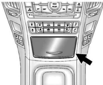
Под панелью управления системой климат-контроля расположено вещевое отделение. Для доступа к нему нажмите на крышку.
