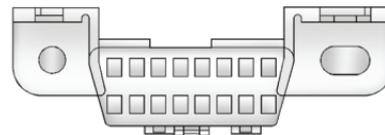
Разъем расположен под приборной панелью, рядом с рулевым колесом. При необходимости обратитесь в авторизованный сервисный центр.
