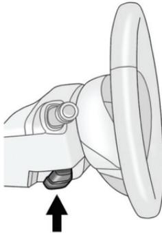
Для регулировки положения рулевого колеса:
