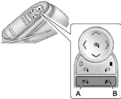
Панель управления наружными зеркалами заднего вида с электрической регулировкой находится в подлокотнике двери водителя.
