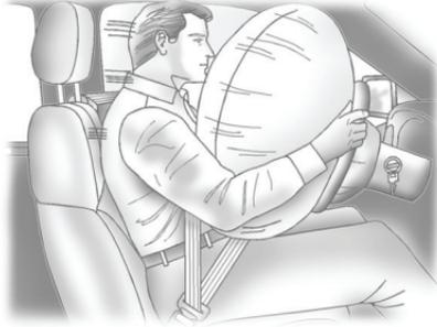
Модуль фронтальной подушки безопасности водителя встроен в центральную часть рулевого колеса.
