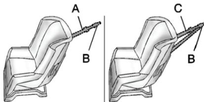
Страховочные лямки (А, С) предназначены для крепления верхней части детского кресла к спинке сиденья автомобиля. Анкер для крепления верхней страховочной лямки установлен на тыльной части спинки сиденья автомобиля. Крепление (В) страховочной лямки детского кресла крепится к соответствующему анкеру для уменьшения перемещения кресла вперед и его наклона как во время движения автомобиля, так и при столкновении.
