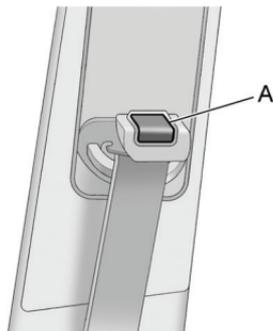
Нажмите кнопку (А) фиксатора и переместите верхнее крепление ремня безопасности в желаемое положение. Верхнее крепление можно переместить вверх, нажав на него и передвинув по направляющей до необходимого положения.
