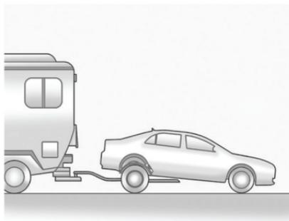
Для буксировки заднеприводного автомобиля с опорой двух колес на дорогу (задняя ось вывешена) выполните следующее.
