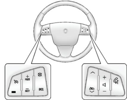
В зависимости от комплектации автомобиля, некоторые кнопки управления аудиосистемой на рулевом колесе могут отличаться. На рулевом колесе могут располагаться следующие органы управления:
