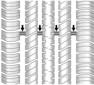
О необходимости замены шин можно судить по индикаторам износа протектора шины. Они оказываются на одной поверхности с беговыми дорожками протектора, когда высота протектора становится равной 1,6 мм. Более подробная информация приведена в подразделах «Проверка состояния шин», стр. 9-57 и «Перестановка колес», стр. 9-57.
