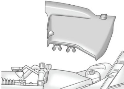
2. Снимите боковую крышку, потянув вверх за ее переднюю часть.
