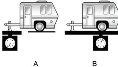
Если вы используете тягово-сцепное устройство с распределителем нагрузки, вертикальная нагрузка (А) должна составлять 10-15 % от массы (В) груженого прицепа.
