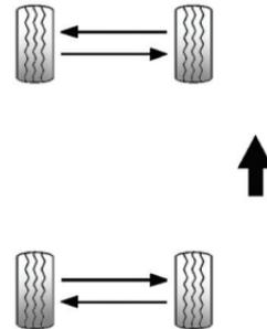
Пользуйтесь данной схемой при перестановке колес, если автомобиль оборудован шинами передних и задних колес с ненаправленным рисунком протектора и различной размерностью.
