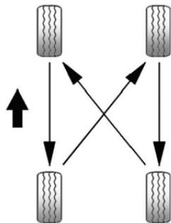
Пользуйтесь данной схемой при перестановке всех четырех колес одного размера.
