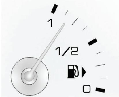
При включенном зажигании указатель уровня топлива показывает приблизительное количество топлива в баке.
