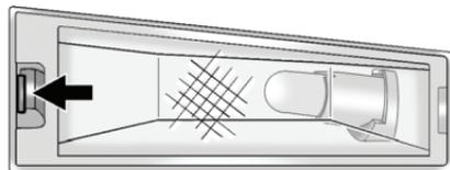
1. Нажмите на защелку, чтобы снять лампу фонаря освещения регистрационного знака.
