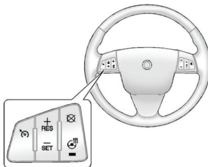
🔥: При нажатии данной кнопки обогрев рулевого колеса включается или отключается. Если светодиод в кнопке активации функции обогрева горит, значит, функция активирована. Рулевое колесо нагревается в течение трех минут.
