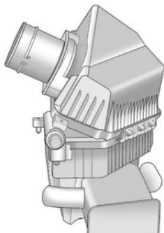
7. Снимите крышку с корпуса воздухоочистителя.
