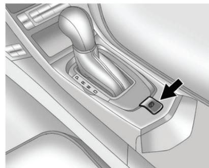
Выключатель стояночной тормозной системы с электроприводом (при соответствующей комплектации) расположен на центральной консоли.
