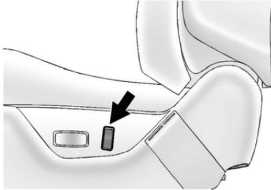
Для изменения наклона спинки с использованием электрического привода (при соответствующей комплектации):
