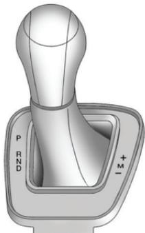
Рычаг селектора коробки передач имеет несколько положений.
