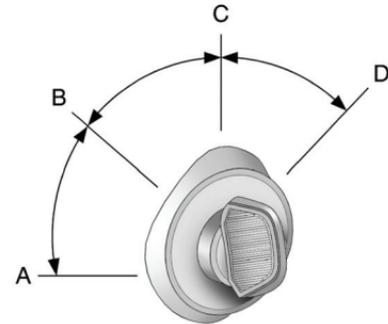
Использование какого-либо инструмента для поворота переключателя зажигания может привести к его повреждению.
