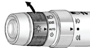
Поворотный переключатель наружных световых приборов расположен около торцевой части левого комбинированного подрулевого переключателя.
