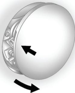
Крышка заливной горловины топливного бака расположена за лючком топливозаливной горловины на правой стороне автомобиля. Лючок горловины топливного бака запирается или отпирается при отпирании или запираении двери водителя с помощью центрального выключателя блокировки замков или кнопки на пульте дистанционного управления.
