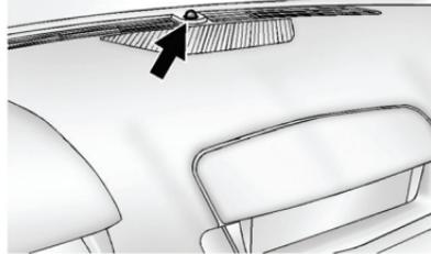
Данный автомобиль оснащен датчиком освещенности, расположенным на вентиляционной решетке, расположенной в верхней части приборной панели, с помощью которого система автоматического управления наружными световыми приборами определяет условия для включения и выключения света фар. Не закрывайте данный датчик – в противном случае фары будут всегда включаться при включении зажигания.
