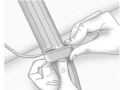
2. Установите направляющую скобу на ремень безопасности так, чтобы обе кромки ремня были расположены внутри скобы.
