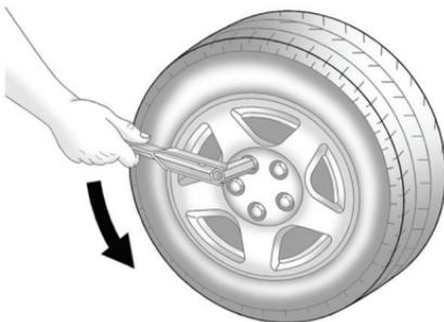
2. Для отворачивания колесных гаек используйте колесный ключ. Не отворачивайте гайки до конца.
