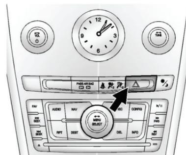
**▲ (Выключатель аварийной световой сигнализации):** При нажатии данной кнопки, расположенной на приборной панели рядом с головным устройством аудиосистемы, будут одновременно мигать передние и задние указатели поворотов. Данный сигнал оповещает окружающих о том, что у вас возникли какие-то проблемы. Чтобы выключить аварийную световую сигнализацию, нажмите кнопку выключателя еще раз.
