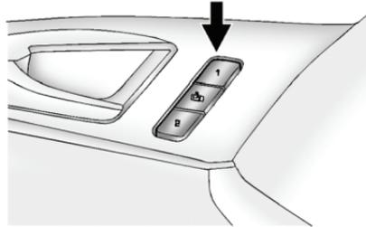
На автомобилях, оборудованных функцией сохранения и вызова настроек, кнопки «1» и «2», расположенные на панели обивки двери водителя, используются для сохранения и вызова настроек положения подушки и спинки сиденья водителя, наружных зеркал и рулевой колонки, при соответствующей комплектации.
