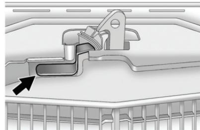
2. Подойдите к передней части автомобиля и найдите рычаг вспомогательной защелки замка капота. Рычаг расположен под передней частью решетки радиатора, ближе к центру. Потяните рычаг защелки замка капота вверх и поднимите капот.
