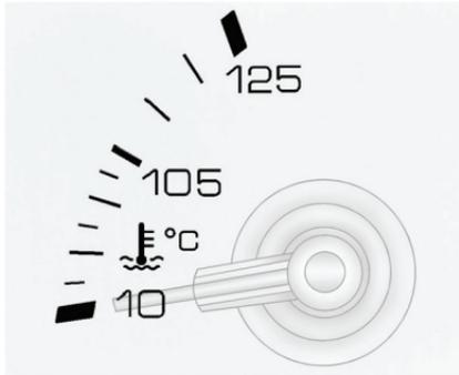
Данный указатель показывает температуру охлаждающей жидкости двигателя.
