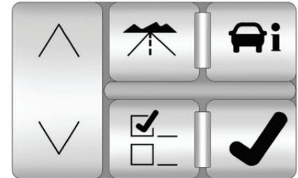
Информационный центр (DIC) может использоваться в различных режимах, которые можно выбрать нажатием кнопок управления информационным центром, расположенных на приборной панели рядом с рулевым колесом.
