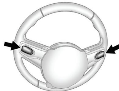
Подрулевые переключатели (при соответствующей комплектации) расположены на тыльной стороне рулевого колеса. Подрулевыми переключателями можно пользоваться, если рычаг селектора установлен в положение «D» (Движение вперед), «M» (Ручной режим) в режиме sport с автоматическим выбором передач или «M» (Ручной режим) с ручным выбором передач.
