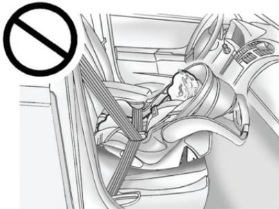
При выборе удерживающего устройства следует принимать во внимание не только массу, рост и возраст ребенка, но и то, подходит ли данное устройство для установки в автомобиль, на котором планируется его использование.
