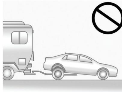
**Важно:** Буксировка полноприводного автомобиля с опорой всех четырех или даже двух колес на дорогу может привести к повреждению компонентов трансмиссии. Не буксируйте полноприводный автомобиль с опорой четырех или двух колес на дорогу.
