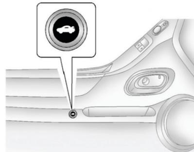
Кнопка дистанционного отпирания крышки багажного отделения находится на панели обивки двери водителя.
