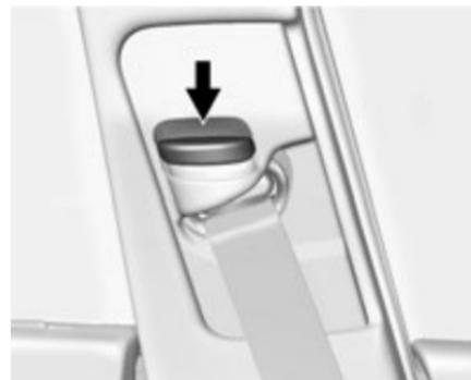
Нажмите на кнопку и отрегулируйте положение верхнего крепления. Регулятор можно передвигать путем нажатия на фиксатор. После того как верхнее крепление установлено в нужное положение, убедитесь, что оно хорошо зафиксировано, потянув его вниз не нажимая на фиксатор.
