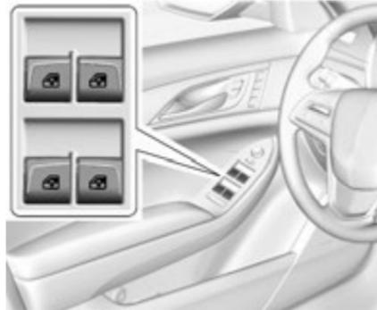
Переключатель на двери водителя контролирует открытие/закрытие окон всех дверей. Переключатели на пассажирских дверях используются для управления только окном своей двери.
