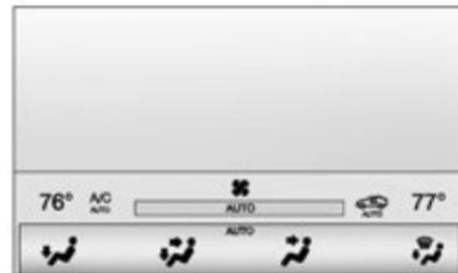
Данный экран кратковременно отображается, при настройке кнопок управления системы климат-контроля. Также здесь можно отрегулировать режимы подачи воздуха.
