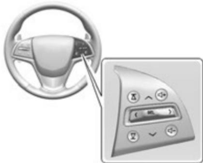
Кнопки  $\wedge$  /  $\vee$  : при нажатии данных кнопок можно передвигаться по списку.
