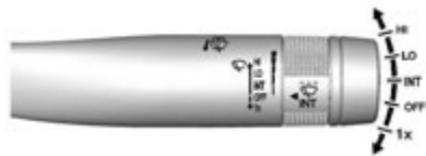
Если зажигание находится в положении «ACC/ACCESSORY» или «ON/RUN/ START» переместите рычаг выбора режимов очистителя/омывателя ветрового стекла, чтобы выбрать частоту движения щеток стеклоочистителя.
