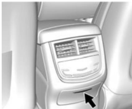
При соответствующей комплектации, нажмите на крышку для открытия вещевого отделения, расположенного в задней части центральной консоли. При соответствующей комплектации внутри данного отделения предусмотрена электрическая розетка.
