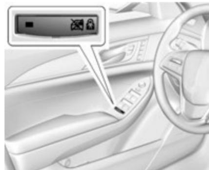
Данная функция блокирует работу окон дверей пассажиров второго ряда сидений.
