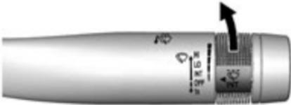
**INT:** Переместите рычаг в положение «INT» для выбора прерывистого режима работы щеток. Поверните кольцо «INT» на рычаге для выбора интервала. Для включения или отключения датчика дождя с функцией Rainsense, см. «*Стеклоочистители Rainsense с датчиком дождя*» в разделе «*Пользовательские настройки*», стр. 5-46.
