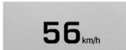
**Вид «Speed»:** При выборе данного экрана отображаются показания спидометра (в единицах британской или метрической системы), ограничение скорости, значение скорости, заданное для адаптивной системы круиз-контроля, сообщения системы предупреждения о смене полосы движения, индикатор впереди идущего автомобиля. Некоторые данные для адаптивной системы, если в автомобиле не установлены данные системы или если они неактивны.
