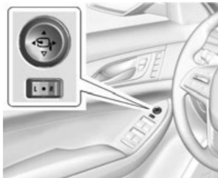
Кнопки регулировки положения наружных зеркал расположены на двери водителя.
