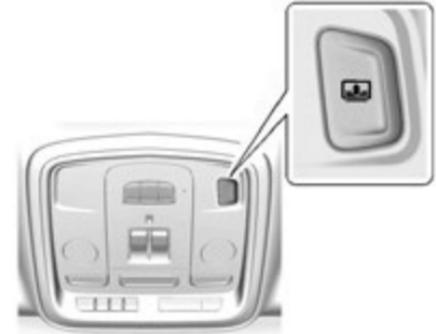
Если автомобиль оборудован солнцезащитной шторкой окна двери багажного отделения, переключатель для данной шторки расположен на потолочной консоли. Питание к переключателю солнцезащитной шторки подается только тогда, когда зажигание находится в положении «ON/RUN/START».
