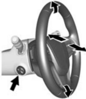
При соответствующей комплектации, кнопки управления положением рулевой колонки расположены в ее левой части.
