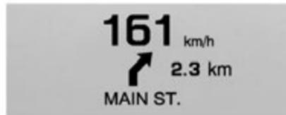
**Вид «Navigation»:** этот экран включает отображение данных о скорости и информации системы навигации с указанием поворотов (при соответствующей комплектации). Компасный курс отображается, когда функция ведения по маршруту отключена.
