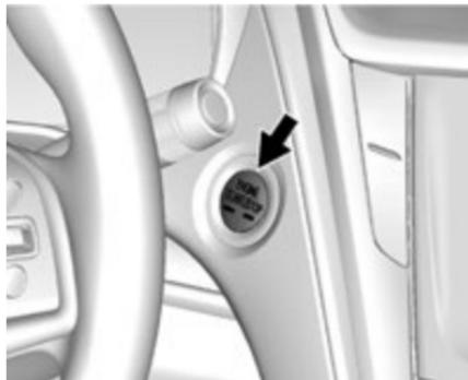
Автомобиль оснащен электронной системой зажигания с кнопкой запуска двигателя/включения зажигания («кнопкой старта»).
