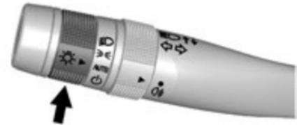
Переключатель наружного освещения расположен на подрулевом рычаге.
