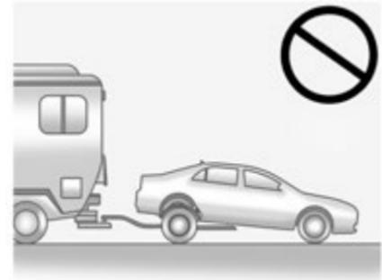
Полноприводные автомобили не подлежат буксировке с опорой двух колес на дорогу.
