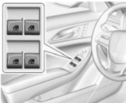
Переключатели управления электрическими стеклоподъемниками, расположенные на двери водителя, обеспечивают управление стеклоподъемниками всех окон автомобиля. Переключатель, расположенный, на двери пассажира переднего сиденья, управляет только стеклоподъемником окна двери пассажира переднего сиденья.
