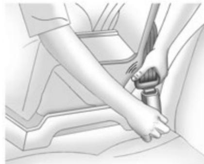
3. Вставьте скобу ремня в замок и нажмите на скобу до характерного щелчка. Если скоба замка не входит в замок полностью, убедитесь, что вы используете правильный замок. Определите положение кнопки разблокировки замка ремня безопасности, чтобы при необходимости ее легко можно было найти, и отстегнуть ремень.
