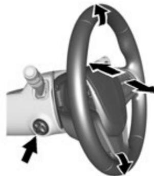
При соответствующей комплектации, кнопки управления расположены слева рулевой колонки.
