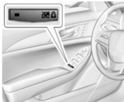
Блокировка замков дверей пассажиров второго ряда сидений предотвращает открытие этих дверей изнутри автомобиля
