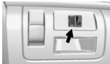
Яркость подсветки приборной панели и кнопок управления на рулевом колесе регулируется.
