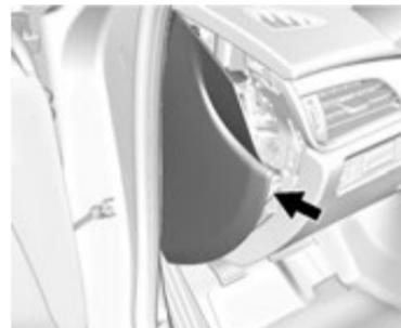
Для получения доступа к блоку предохранителей снимите крышку с торцевой части приборной панели, аккуратно приподнимая ее с помощью пластикового рычага в местах крепления, начиная с точки, указанной на рисунке выше.
