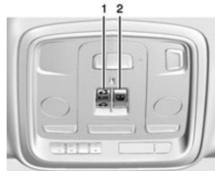
Открытие или закрытие вентиляционного люка производится с помощью переключателя (1) со стороны водителя.
