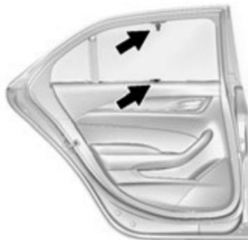
При соответствующей комплектации, потяните шторку за ручку вверх и закрепите в верхней части окна. Также предусмотрена маленькая шторка для заднего уголка стекла, отделенного перегородкой.
