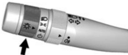
Переключатель наружных световых приборов находится на левом комбинированном подрулевом рычаге.
