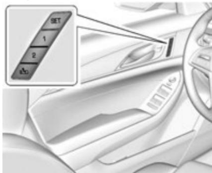
При соответствующей комплектации кнопки «1», «2», «SET» и
