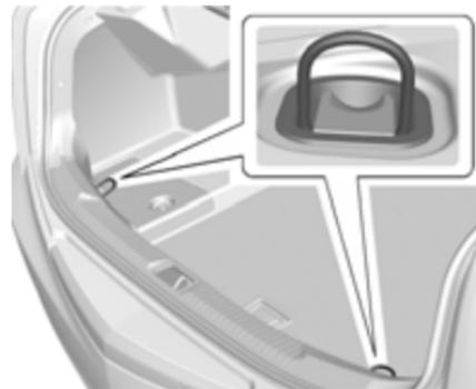
Петли системы фиксации предусмотрены для закрепления небольших грузов внутри багажного отделения.
