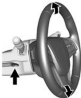
Для регулировки положения рулевого колеса:
