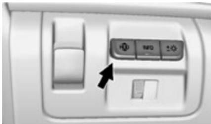
Кнопка включения/отключения проекционного дисплея находится слева от рулевого колеса.
