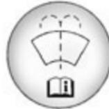
Откройте крышку с соответствующим символом. Долейте жидкость омывателя стекол так, чтобы был заполнен весь бачок. См. раздел «*Моторный отсек*», стр. 10-7.
