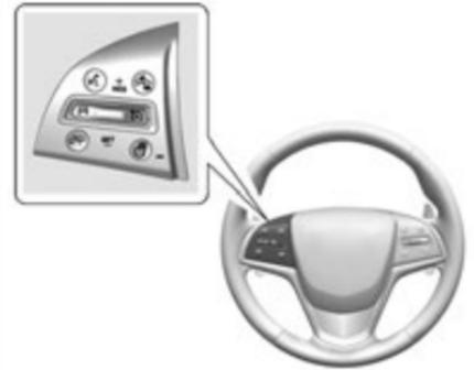
Кнопка управления системой предупреждений о столкновении находится на рулевом колесе.
