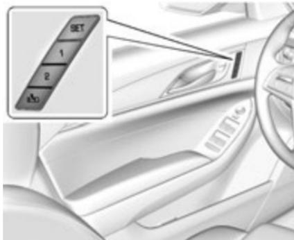
При соответствующей комплектации кнопки «1», «2», «SET» и
