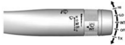
Включите щетки стеклоочистителей для выбора скорости их работы; при этом зажигание должно быть в положении «ACC ACCESSORY» или «ON/RUN/START».
