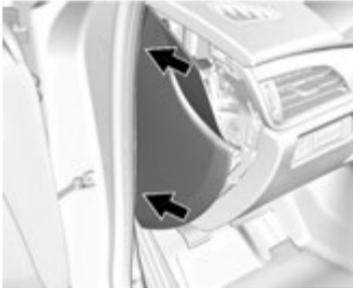
Для установки торцевой крышки приборной панели обратно вставьте ушки, расположенные на крышке в пазы приборной панели в точках, указанных на рисунке выше. Выровняйте места крепления в соответствии с пазами приборной панели и нажатием установите крышку.
