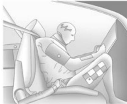
При движении в автомобиле вы перемещаетесь с той же скоростью, что и автомобиль. Если автомобиль резко останавливается, вы продолжаете движение до тех пор, пока вас что-нибудь не остановит. Это может быть ветровое стекло, приборная панель или ремни безопасности!
