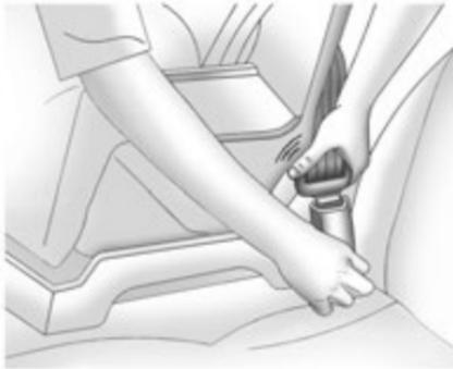
4. Вставьте скобу ремня в замок и нажмите на скобу до характерного щелчка. Определите положение кнопки разблокировки замка ремня безопасности, чтобы при необходимости ее легко можно было бы найти, и отстегнуть ремень.
