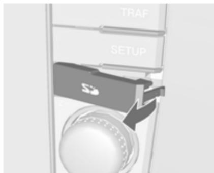
Крышку можно снять, например, с помощью скрепки или другого подходящего предмета.
