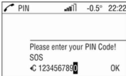
Введите PIN-код с использованием дискового регулятора и подтвердите кнопкой **OK**.
