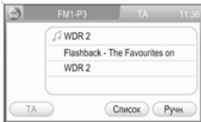
Пример для меню радиоприемника: кнопки **ТА**, **Список** и **Ручн.** можно выбрать/активировать только с помощью сенсорного экрана.
