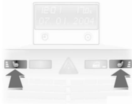
Для установки нужного подогрева соответствующего сиденья нажмите один или несколько раз на кнопку
