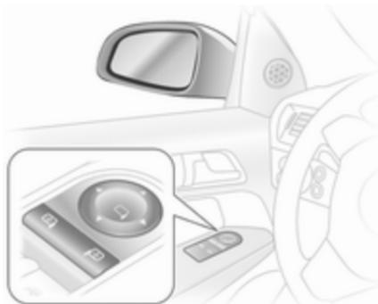
Сначала выберите зеркало, которое нужно отрегулировать, потом отрегулируйте его положение поворотом ручки управления.
