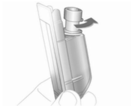
4. Поверните патрон лампы против часовой стрелки, пока он не освободится.
