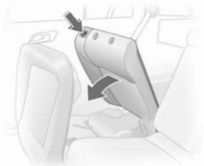
Разблокируйте спинку сиденья (одноместного или раздельного) с помощью кнопки фиксатора, сложите ее вперед и зафиксируйте.
