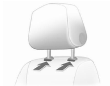
Отожмите пружину фиксатора и вытяните подголовник.
