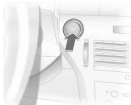
Электронный ключ должен находиться внутри автомобиля. Выжмите педали сцепления и тормоза, установите автоматическую коробку передач в положение **P** или **N**, педаль акселератора должна быть отпущена, на дизельных двигателях: быстро нажмите и отпустите кнопку предварительного прогрева, слегка поверните
