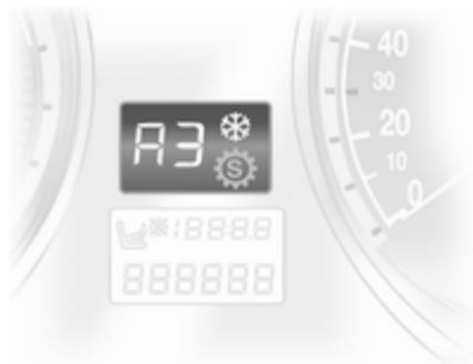
Индикация режима и включенной передачи.
