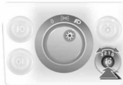
Чтобы изменить угол наклона фар с учетом загрузки автомобиля во избежание ослепления: Нажмите
