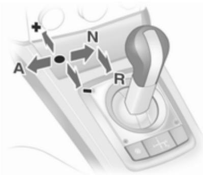
Всегда передвигайте селектор передач в нужном направлении до упора. Отпущенный, он автоматически возвращается в центральное положение.
