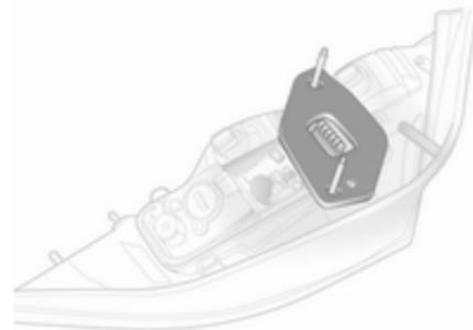
7. Установите уплотнение в патрон лампы. Проверьте, ровная ли поверхность уплотнения в области болтов.
