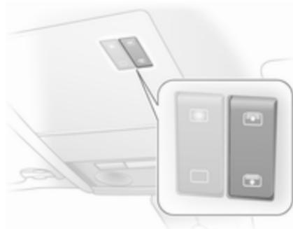
Солнцезащитная шторка оснащена электрическим приводом.
