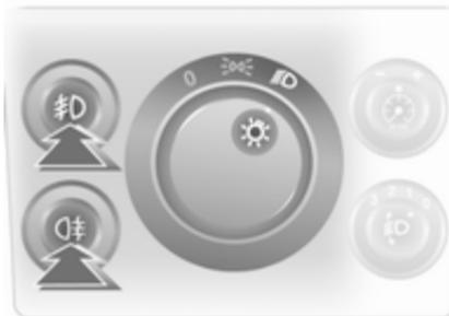
Передние противотуманные фары можно включить только при включенном зажигании и включенных фарах или стояночных огнях.
