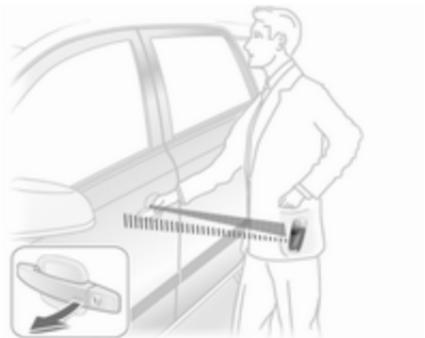
Если при наличии электронного ключа легко потянуть за ручку двери, то автомобиль отпирается, а соответствующая дверь открывается. Чтобы открыть заднюю дверь, нажмите на кнопку под молдингом.
