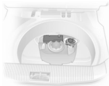
Комплект для ремонта шин хранится в вещевом ящике под крышкой пола багажного отделения.
