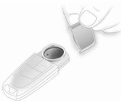
Для замены батарейки нажмите фиксатор и, слегка нажав, снимите колпачок. Надавите колпачок на противоположной стороне снаружи.
