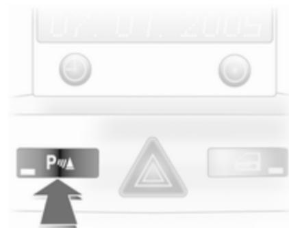
При включении передачи заднего хода система включается автоматически.
