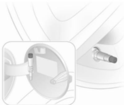
На автомобилях с системой контроля давления в шинах наворачните на вентиль переходник.
