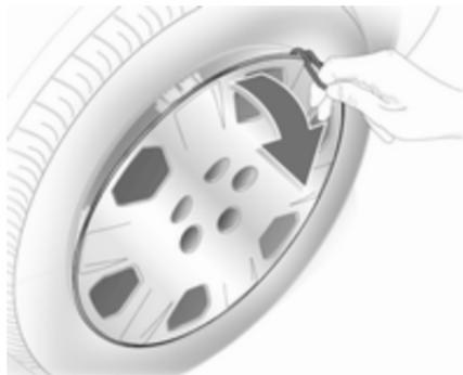
1. Снимите колесный колпак с помощью крюка. Автомобильный инструмент ⇨ 209.
