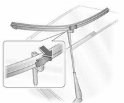
Поднимите рычаг стеклоочистителя, наклоните щетку на 90° к рычагу и снимите ее движением вбок.
