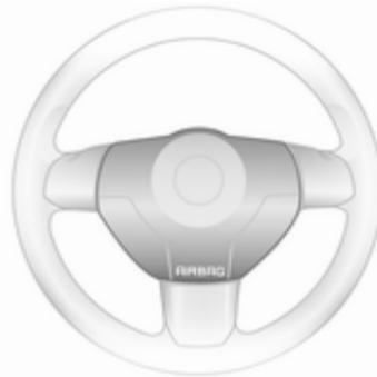
Система передних подушек безопасности состоит из двух подушек: одной в рулевом колесе и одной в приборной панели со стороны переднего пассажира. Эти подушки можно определить по надписи **AIRBAG**.
