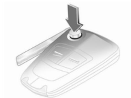
Для раскрытия нажмите на кнопку. При складывании ключа сначала нажмите кнопку.
