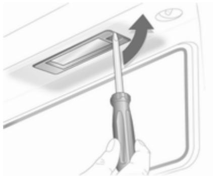
1. Вставьте отвертку в корпус, надавите в сторону и освободите пружину.
