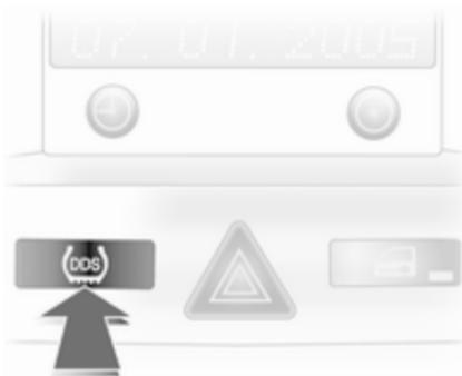
После подкачки шин или смены колеса систему нужно инициализировать: Включите зажигание, нажмите и удерживайте кнопку **DDS** примерно 4 секунды, индикатор (⚠) должен мигнуть три раза.
