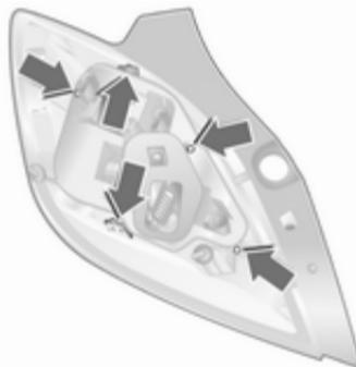
5. Выкрутите с помощью отвертки три винта. Нажмите на фиксирующие выступы на внутренней стороне держателя лампы и снимите держатель лампы.
