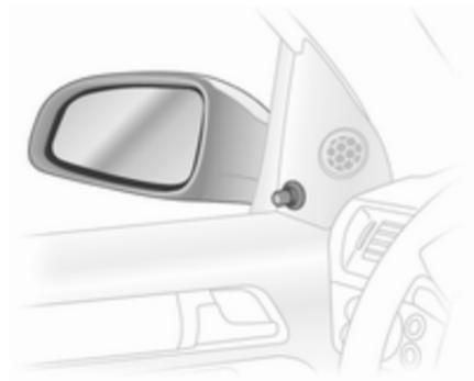
Отрегулируйте зеркала, передвигая рычаг в нужном направлении.
