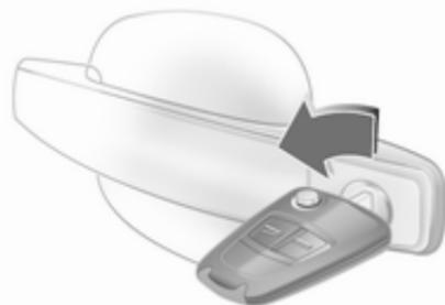
Поверните ключ или аварийный ключ  $\varnothing 25$  в замке двери водителя насколько возможно. При открывании двери водителя разблокируется весь автомобиль.
