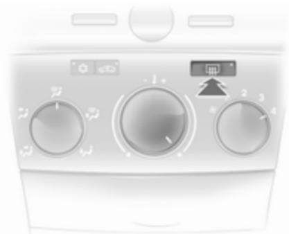
Включается при нажатии кнопки
