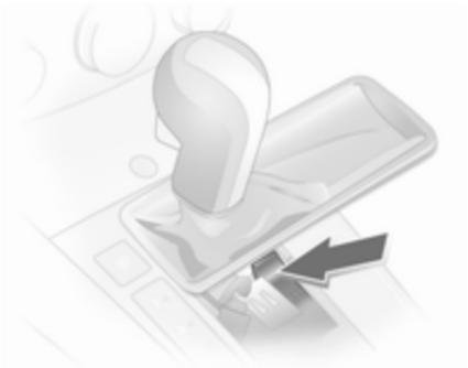
3. С помощью отвертки сожмите желтую пружину фиксатора вперед и передвиньте рычаг селектора из положения **P**.
