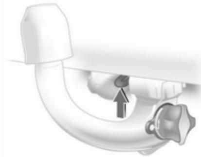
Заблокируйте тягово-сцепное устройство, повернув ключ в положение
