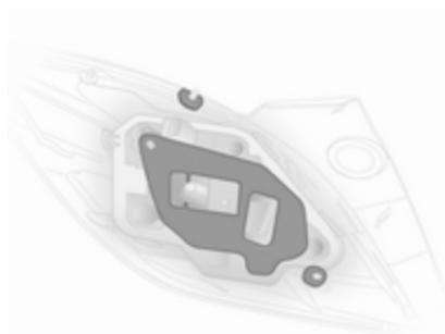
8. Проверьте, вложены ли уплотнения в патрон лампы и зафиксированы ли винты.
