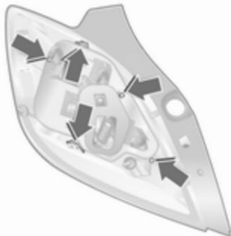
5. Удалите уплотнение с крепежного болта. Нажмите на фиксирующие выступы на внешней стороне держателя лампы и снимите держатель лампы.
