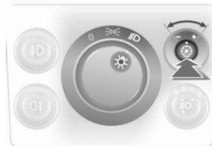
Яркость подсветки можно отрегулировать при включенном наружном освещении: Разблокируйте кнопку
