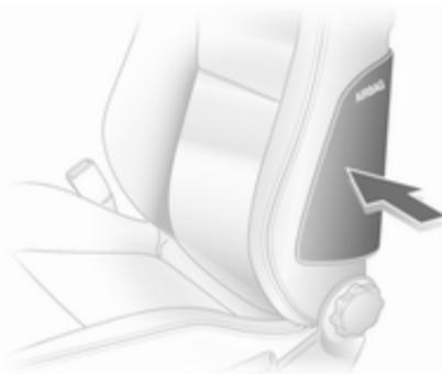
Система боковых подушек безопасности состоит из подушек, установленных в спинках передних сидений. Эти подушки можно определить по надписи **AIRBAG**.
