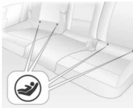
Прикрепить разрешенную для применения в автомобиле систему крепления ISOFIX детских кресел безопасности к монтажным кронштейнам ISOFIX. Позиции крепления ISOFIX детских кресел безопасности, применяемые для конкретного автомобиля, отмечены в таблице сокращением IL.
