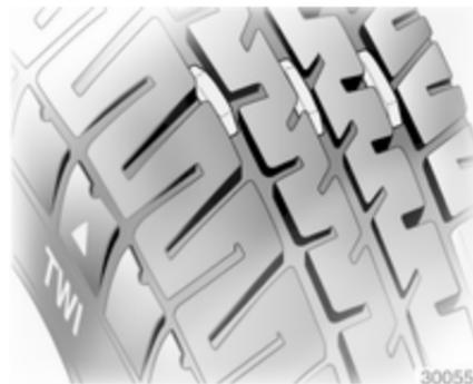
Установленной правилами минимальной глубине рисунка протектора (1,6 мм) соответствует появление индикаторов износа (TWI). Места индикаторов отмечены на боковине покрывки.
