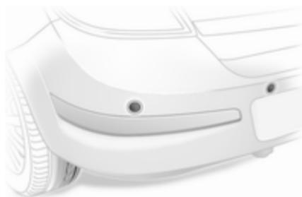
Система помощи при парковке облегчает парковку автомобиля, измеряя для этого расстояние между автомобилем и препятствиями. Однако это не в коей мере не снимает с водителя ответственность за постановку автомобиля на стоянку.
