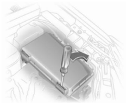
Вставьте отвертку в отверстие как можно глубже и наклоните ее в сторону. Поднимите крышку вверх и снимите ее.
