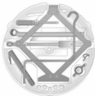
Домкрат и набор инструментов находятся в вещевом отсеке в чехле под запасным колесом. Запасное колесо ⇨ 221
