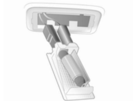
2. Слегка надавите лампу в направлении пружинного зажима и выньте ее.
