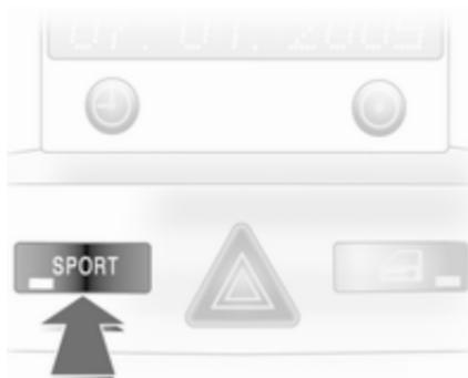
Система ESP®Plus может быть отключена при включении для повышения эффективности вождения в режиме Sport:
