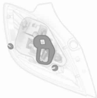
8. Проверьте, вложены ли уплотнения в патрон лампы и зафиксированы ли винты.
