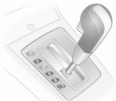
Селектор передач можно передвинуть из положения **P** или **N** только при включенном зажигании и нажатой педали тормоза (блокировка селектора передач).
