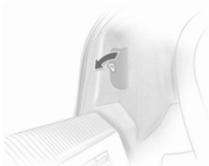
1. Для замены ламп передвиньте фиксатор и снимите крышку в багажном отделении.
