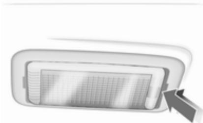
1. Выдавите фонарь с помощью отвертки.
