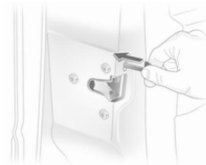
Вставьте ключ или аварийный ключ ⇨ 25 в отверстие над замком на внутренней стороне двери и нажимайте на замок до щелчка. Потом закройте дверь. Эту процедуру необходимо выполнить для каждой двери. Кроме того, водительскую дверь можно запереть ключом снаружи. Крышка горловины топливного бака и задняя дверь/крышка багажника не запираются.
