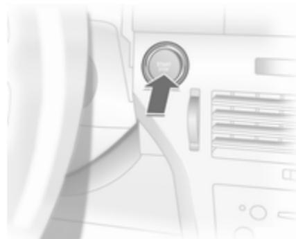
Электронный ключ должен находиться внутри автомобиля. Выжмите педали сцепления и тормоза, установите автоматическую коробку передач в положение **P** или **N**, педаль акселератора
