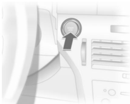
Нажмите кнопку **Start/Stop**. Включится зажигание. Отключатся электронный иммобилайзер и блокировка рулевого колеса.
