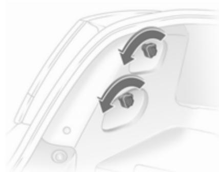
1. Выкрутите стопорные гайки.
