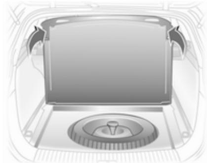
Удалите переходник и крюки из направляющих в стенках багажного отделения. Поднимите задние крепежные проушины и установите крышку пола в вертикальное положение таким образом, чтобы она опиралась о панель крыши. При за-
