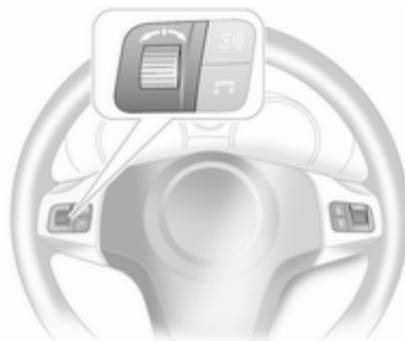
Нажмите на маховичок, чтобы открыть меню **BC (бортовой компьютер)**. Воспользуйтесь пунктом меню **BC (бортовой компьютер)**, для запуска и остановки секундомера или повторного запуска измерения и расчета.
