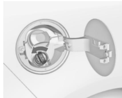
4. Скрутите предохранительную пробку с заправочной горловины.
