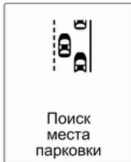
Когда автомобиль с включенной системой проезжает мимо ряда припаркованных автомобилей, расширенная система помощи при парковке начинает искать свободное место для парковки. При обнаружении подходящего места на дисплей информационного центра водителя выводится визуальное предупреждение и подается звуковой сигнал.
