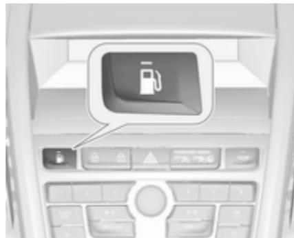
Нажатие на кнопку
