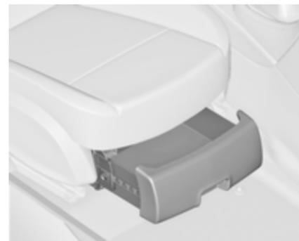
Утопите кнопку в гнезде и вытащите ящик наружу. Максимальная нагрузка: 3 кг. Чтобы закрыть ящик, нажать на него до фиксации.
