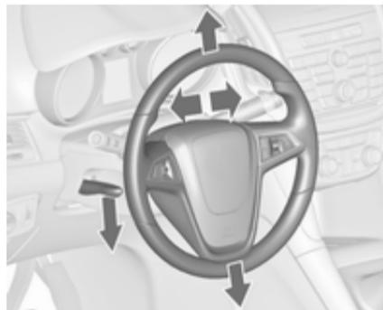
Разблокировать рычаг, отрегулировать рулевое колесо, затем заблокировать рычаг и убедиться, что он полностью зафиксирован.
