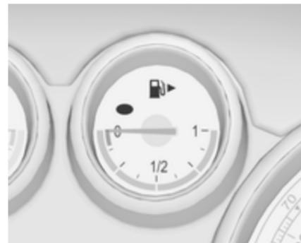
В зависимости от режима работы показывает уровень топлива или давление газа в баке.
