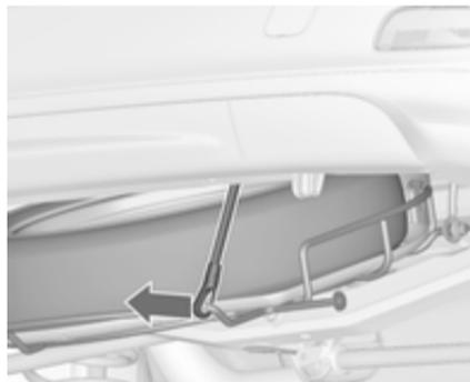
7. Снимите предохранительный трос.
