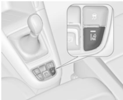
Система предупреждения о выходе за пределы полосы движения включается нажатием на кнопку
