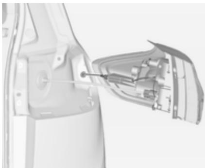
3. Аккуратно вытянуть фонарь в сборе из крепежных штырьков и снять его.
