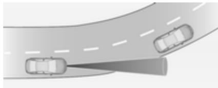
Система адаптивного круиз-контроля рассчитывает предполагаемую траекторию движения автомобиля, используя данные о центробежной силе. При расчете траектории учитывается кривизна участка, по которому автомобиль движется
