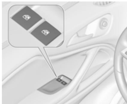
Потяните или нажмите клавишу выключателя стеклоподъемника, чтобы поднять или опустить стекло.
