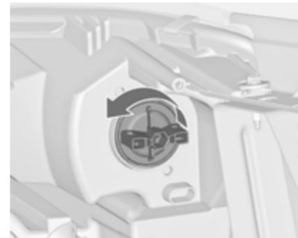
1. Поверните патрон (3) против часовой стрелки, чтобы отсоединить его. Извлеките патрон лампы из отражателя.
