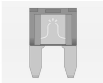
В зависимости от типа неисправный предохранитель можно определить по сгоревшей плавкой вставке. Замену предохранителя производить только после устранения причины его выхода из строя.
