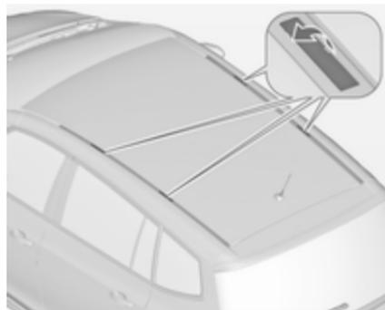
Чтобы закрепить багажник на крыше, извлеките заглушки из отверстий на крыше. Вставьте в указанные на иллюстрации отверстия крепежные кронштейны, руководствуясь инструкцией.
