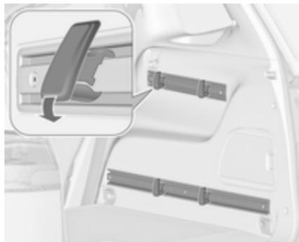
Вначале вставить крюк в требуемое положение в верхнюю канавку направляющей, а затем прижать его в нижнюю канавку. Чтобы снять, вначале вытянуть крюк из верхней канавки.
