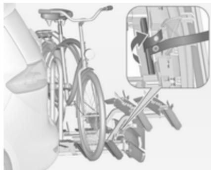
4. Протяните ремень, закрепленный на кронштейне, под рычагом, чтобы сложить заднюю систему перевозки грузов. Застегните ремень.
