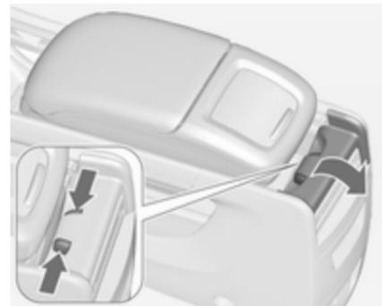
Сожмите вместе кнопки фиксатора, расположенного в задней части подлокотника и откиньте его вниз.
