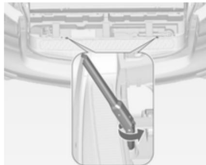
3. Установите баллонный ключ на один из болтов с шестигранной головкой и поворачивайте его против часовой стрелки, пока не почувствуете заметное сопротивление.
