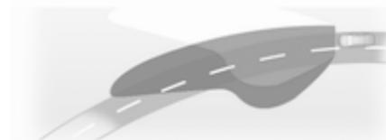
В зависимости от положения рулевого колеса и скорости движения происходит поворот светового луча, чем достигается улучшенная освещенность полотна дороги во время прохождения поворота.
