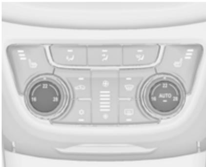
Если установлена минимальная температура (Lo) и включен режим охлаждения
