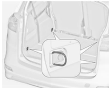
Крепежные проушины предназначены для предотвращения смещения предметов, например, с помощью крепежных ремней или багажной сетки.
