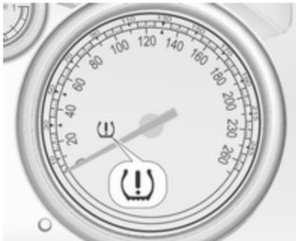
В случае выявления падения давления воздуха в шине загорится сигнализатор (⚠) ⇨ 128.
