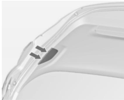
1. Откройте заднюю дверь багажного отделения и снимите заглушку.
