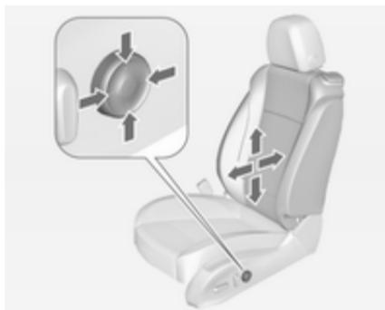
Отрегулируйте поясничную опору четырехпозиционным переключателем, чтобы настроить регулировку в соответствии с личным предпочтением.
