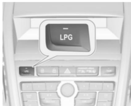
Нажатие на кнопку **LPG** переключает режимы работы с бензина на сжиженный газ и наоборот. Состояние светодиода
