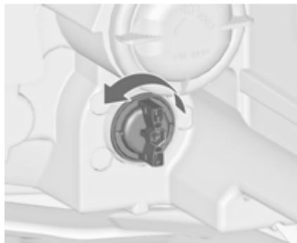
1. Поверните патрон (2) против часовой стрелки, чтобы отсоединить его. Извлеките патрон лампы из отражателя.
