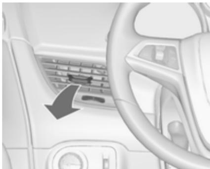
Чтобы закрыть отверстие, поверните регулировочный маховичок в положение **0**.
