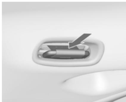
Вставьте защелки в держатель ремня безопасности на крыше, при этом нижний язычок защелки должен быть направлен вперед.
