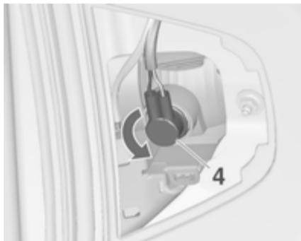
2. Повернуть патрон лампы против часовой стрелки и извлечь его из рефлектора.
