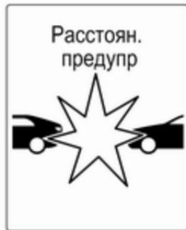
Если дистанция до движущегося впереди транспортного средства становится опасной или скорость сближения является слишком высокой, в результате чего возникает угроза столкновения, на дисплее информационного центра водителя загорается сигнализатор опасности столкновения.
