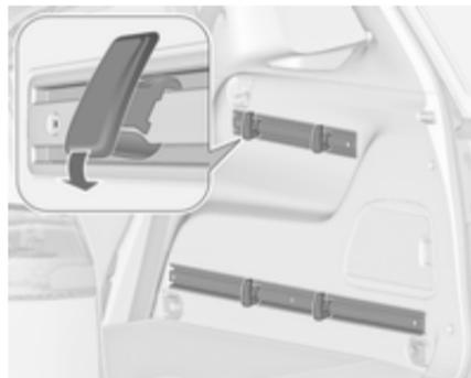
Установите крюки в направляющих в нужном положении: вставьте крюк в верхний паз направляющей и вдавите его в нижний паз.
