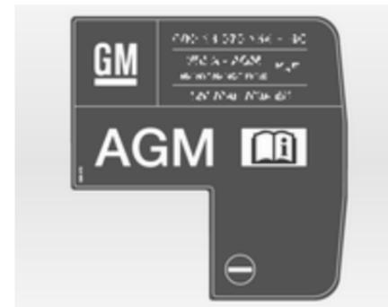
Аккумулятор AGM имеет специальное обозначение на корпусе. Рекомендуется использовать для автомобиля фирменные аккумуляторы компании Opel.
