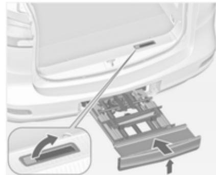
Нажмите вверх и удерживайте рычаг фиксатора. Слегка приподнимите заднюю систему перевозки грузов и задвиньте ее в бампер до фиксации.
