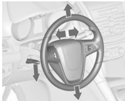
Отоприте рычаг, отрегулируйте рулевое колесо, затем зафиксируйте рычаг и убедитесь, что он полностью заблокирован.
