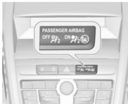
Если после включения зажигания контрольный индикатор **ВКЛ**
