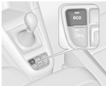
Чтобы принудительно отключить систему автоматической остановки и пуска двигателя, нажмите клавишу **eco**. Выключение подтверждается погасанием подсветки клавиши.
