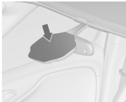
Не допускайте попадания на датчик пыли, грязи и льда.
