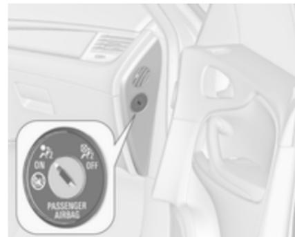
Систему воздушных подушек безопасности переднего пассажира можно отключить ключом, вставив его в выключатель с замком, который расположен с правой стороны приборной панели.
