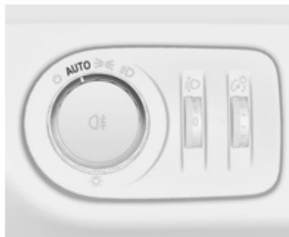
При включенном автоматическом управлении освещением и работающем двигателе осуществляется автоматический переход между режимами дневного света фар и штатным режимом работы фар в соответствии с условиями освещенности и показаниями датчика дождя.
