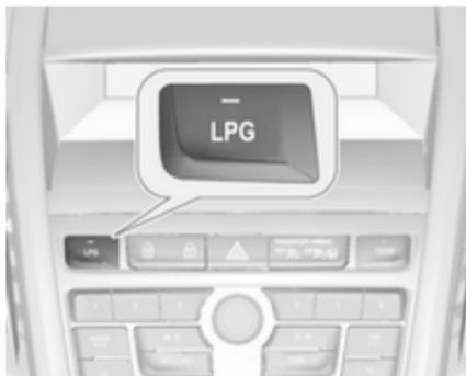
При нажатии клавиши **LPG** происходит переключение с бензина на СНГ, как только будут выполнены необходимые для этого условия (температура охлаждающей жидкости, температура газа и минимальная скорость вращения коленчатого вала двигателя). Эти условия обычно выполняются примерно через 60 секунд (в зависимости от температуры окружающей среды) и после первого выжимания педали акселератора. Состояние светодиода соответствует текущему рабочему режиму.
