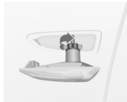
2. Поверните патрон против часовой стрелки и выньте его из корпуса фонаря.
