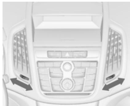
Чтобы открыть вентиляционное отверстие, следует повернуть колесико регулятора в положение I. Регулировка количества воздуха, вы-
