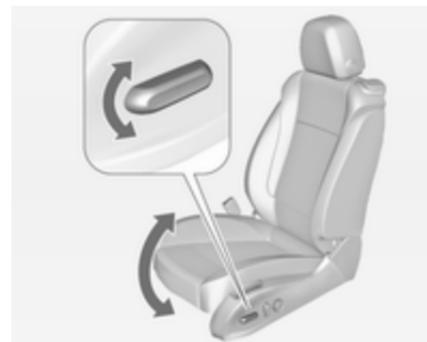
Сдвиньте передний край клавиши переднего выключателя вверх/вниз.
