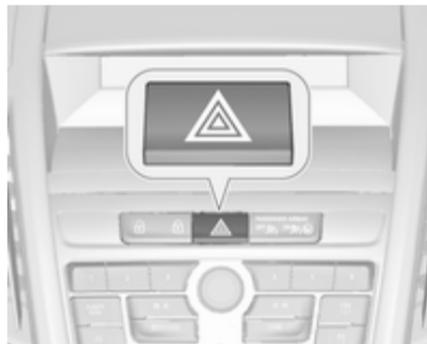
Включается с помощью кнопки
