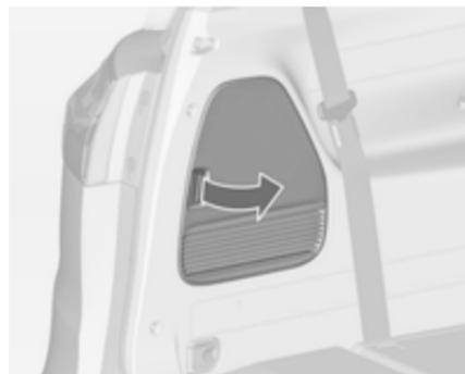
Если автомобиль укомплектован набором для ремонта шин, извлеките всю коробку.
