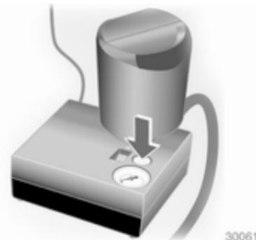
Если после 10 минут заданное давление не установилось, снимите комплект для ремонта шин. Сдвиньте автомобиль, чтобы колеса сделали полный оборот. Снова установите комплект для ремонта шин и продолжайте накачивать шину еще 10 минут. Если требуемое давление все равно не устанавливается, шина повреждена очень сильно. Обратитесь за помощью на станцию техобслуживания.
