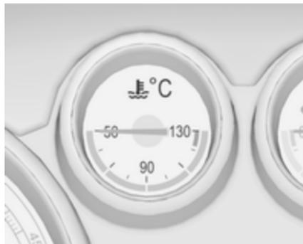
Отображает температуру охлаждающей жидкости двигателя.
