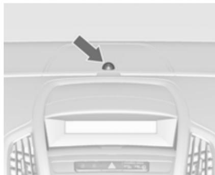
Светодиод индикации состояния встроен в датчик, расположенный на верхней части приборной панели.
