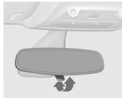
Для уменьшения бликов отрегулируйте положение рычага на нижней части корпуса зеркала.
