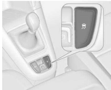
Систему контроля тягового усилия ТС можно выключить, если требуется пробуксовка ведущих колес автомобиля, для этого кратковременно нажмите кнопку
