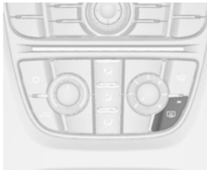
Включается при нажатии кнопки
