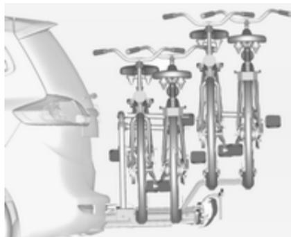
Задняя система перевозки грузов (система Flex-Fix) позволяет перевозить два велосипеда на выдвижной каретке, встроенной в днище автомобиля. С помощью дополнительного кронштейна можно закрепить еще два велосипеда. Транспортировка других объектов запрещена.
