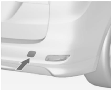
Вставьте отвертку в прорезь у нижнего края заглушки. Освободить колпачок, аккуратно сдвинув отвертку вниз. Во избежание повреждения рекомендуется поместить между отверткой и рамой тряпку.
