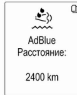
Если уровень AdBlue падает ниже определенного значения, выдается предупреждение о низком уровне **AdBlue Расстояние:**, и в информационном центре водителя (DIC) отображается **2400 км**.
