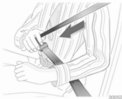
Вытянуть ремень безопасности из подматывающего механизма, не перекручивая направить его поперек туловища и вставить язычок застегивающей части ремня безопасности в пряжку. Во время движения автомобиля следует регулярно подтягивать поясную часть ремня, вытягивая ремень за плечевую часть.
