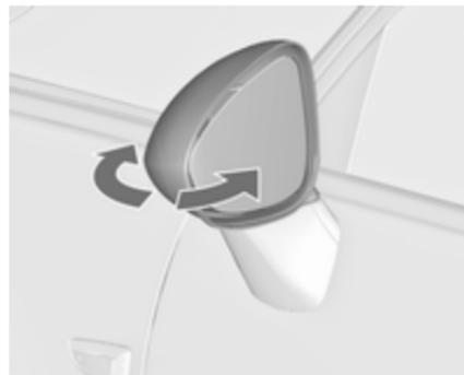
Для обеспечения безопасности пешеходов внешние зеркала складываются от удара определенной силы. Для того чтобы вернуть зеркало в рабочее положение, нужно слегка надавить на его корпус.
