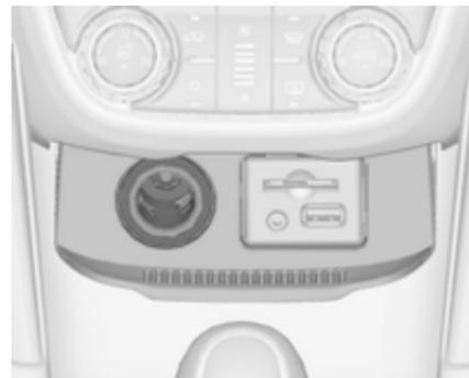
Розетка электропитания напряжением 12 вольт располагается в передней консоли. Опустить крышку вниз.
