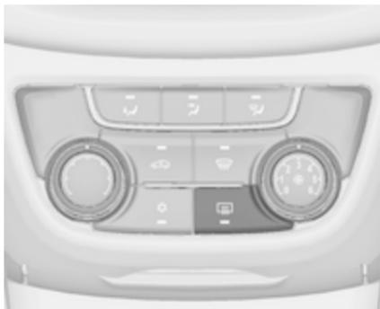
Включается при нажатии кнопки
