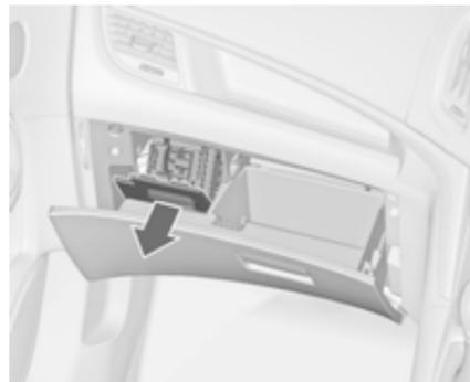
На автомобилях с правосторонним рулевым управлением блок предохранителей расположен за крышкой в перчаточном ящике. Открыть передний вещевой ящик, затем открыть крышку и опустить ее вниз.
