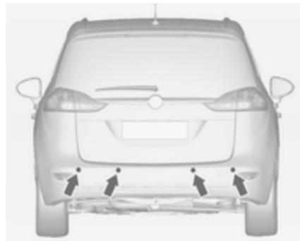
В состав системы входят по четыре ультразвуковых датчика в заднем и в переднем бамперах.
