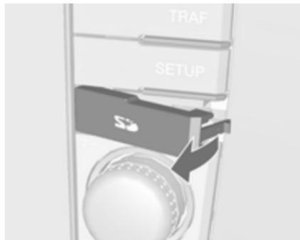
Крышку можно снять, например, с помощью скрепки или аналогичного приспособления.
